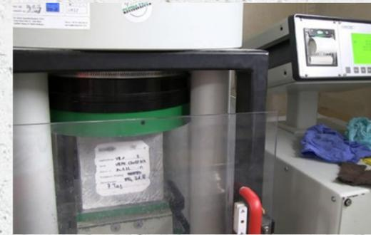
Druckfestigkeitsversuch mit einem Betonwürfel.
